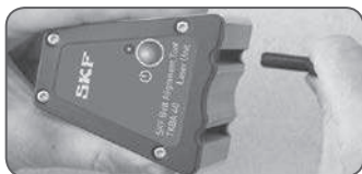
Рис 2 Установка и удаление V-направляющих
