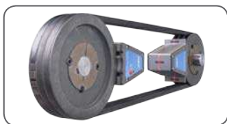
图4 激光单元装到皮带轮槽的示意图
