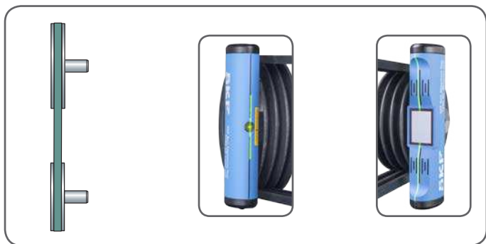
Рисунок 9 Соосность шкивов после правильно выполненной выверки
