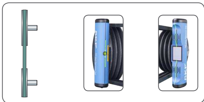
Figure 9 Poulies parfaitement alignées
