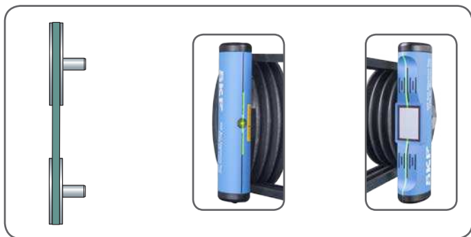
Figure 9 Pulegge perfettamente allineate
