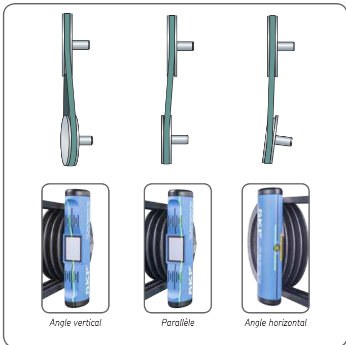
Figure 5 Résumé du désalignement
