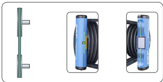
图 9 皮带轮已完美对中
