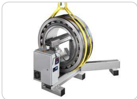
图4: TIH L加热垂直放置工件
