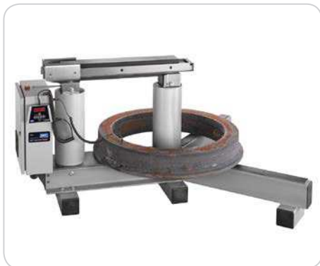
Figura 5: TIH L con riscaldamento di un pezzo orizzontale in lavorazione
