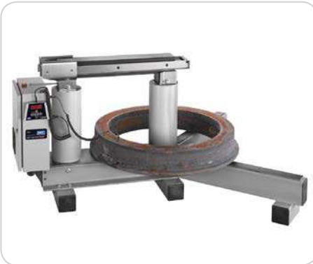
Bild 5: TIH L zum Anwärmen von Werkstücken in horizontaler Position
