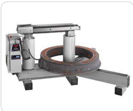
Figura 5: TIH L com aquecimento de peças horizontal
