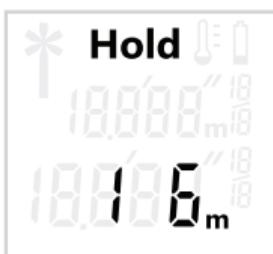
Presione la tecla “HOLD” **1** para detener el proceso de medición. El rayo láser se desconecta y la indicación **HOLD** aparece en el display. El valor de medición actual se sigue indicando en la línea inferior del display, pero no se sigue actualizando continuamente.
