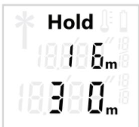
Pressionar o botão “**HOLD**” 1 mais uma vez para interromper o procedimento de medição novamente. O feixe do laser é desligado e a indicação **HOLD** aparece no display. O valor de medição anterior é exibido na linha superior. O valor de medição atual é exibido na linha inferior, mas não é mais atualizado de forma contínua.
