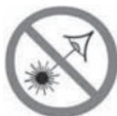
NÃO direcionar o feixe do laser para pessoas ou animais e não olhar diretamente para o feixe do laser. Esta ferramenta produz radiação laser classe 2 e está em conformidade com 21 CFR 1040.10 e 1040.11, exceto para variações em conformidade ao Aviso Laser nº 50, de 24 de junho de 2007. Isto pode levar pessoas a serem cegadas.
