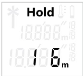
Pressionar o botão “Ligar/Desligar” **1** para interromper o procedimento de medição. O feixe do laser é desligado e a indicação **HOLD** aparece no display.
