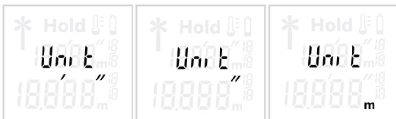
Apague la herramienta de medición. Presione el botón de medición **1** y manténgalo presionado hacia abajo. La pantalla mostrará alternadamente ambas unidades de medida. Cuando se muestre el ajuste deseado, suelte el botón de medición **1**. Se almacenará el ajuste.
