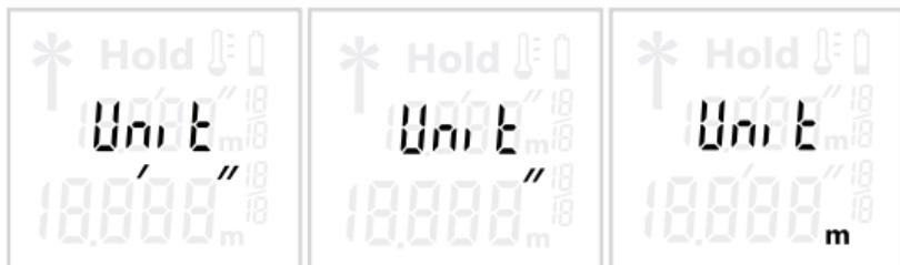
Desligar a ferramenta de medição. Pressionar o botão de medição 1 e segurá-lo nesta posição. O display exibirá alternadamente ambas as unidades de medida. Quando a configuração desejada for exibida, liberar o botão de medição 1. A configuração está gravada.
